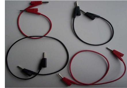
Un fil de connexion permet de relier les appareils entre eux: il permet de « transporter » le courant dans le circuit.
